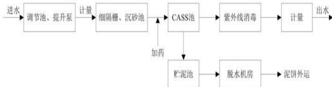
图4-1 恩平产业转移工业园污水处理厂工艺流程图
