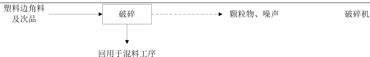
图 2-4 塑料边角料及次品生产工艺流程及产污环节图
