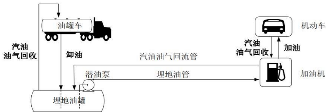
图 2-2 加油站设备衔接流程图
