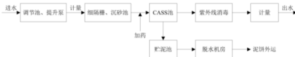
图4-1恩平产业转移工业园污水处理厂工艺流程图
