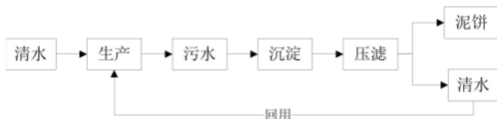
图 4-1 生产废水处理工艺流程图
