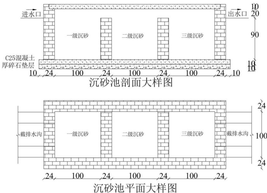
图 4-14 1#、2#、3#、4#、5#、7#、8#沉砂池设计大样图（单位：cm）
