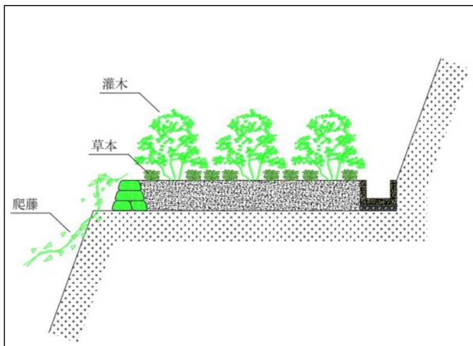
图 4-17 露天采场台阶复垦大样图
