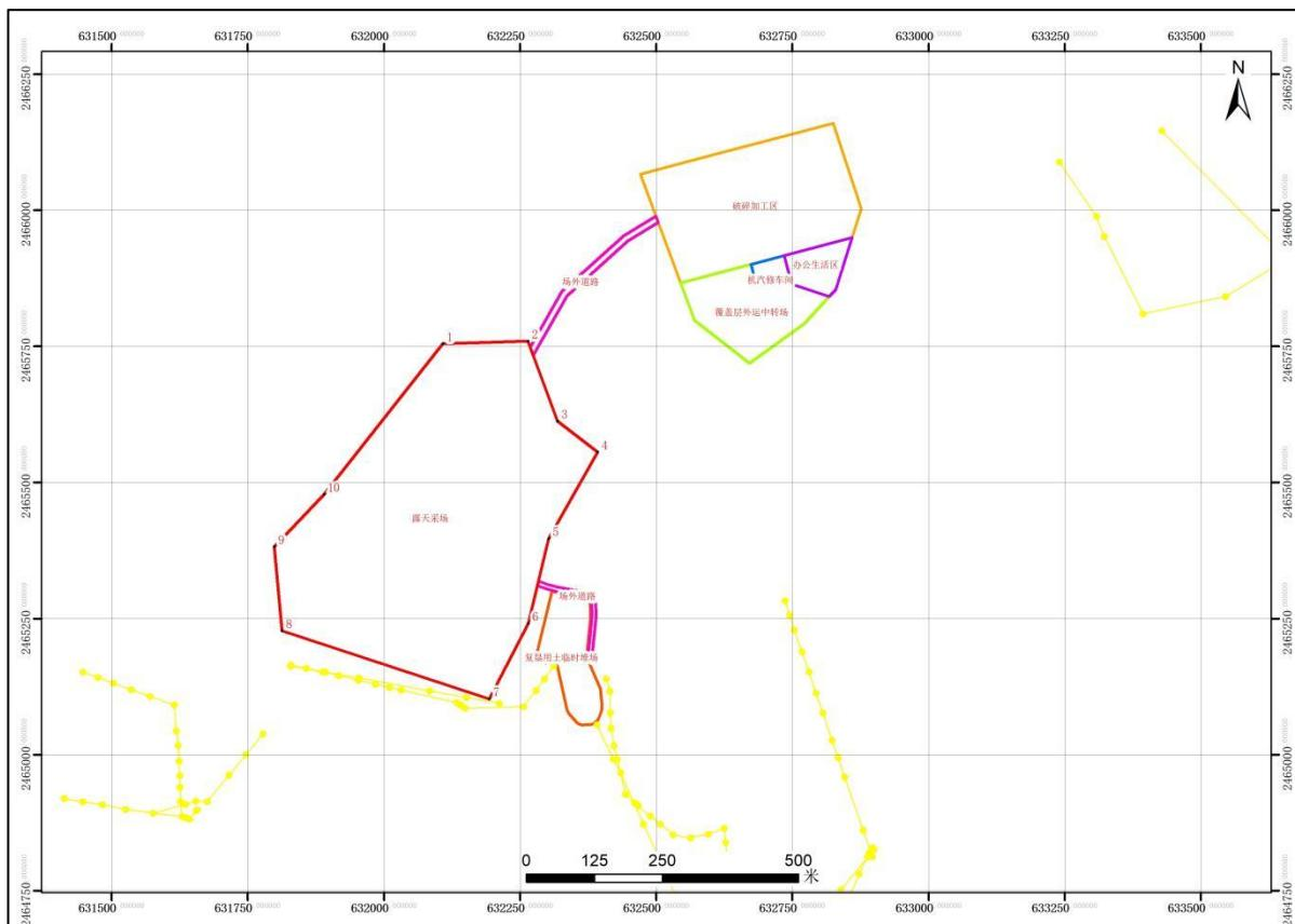
图 2-18 矿区周围输电线分布图
