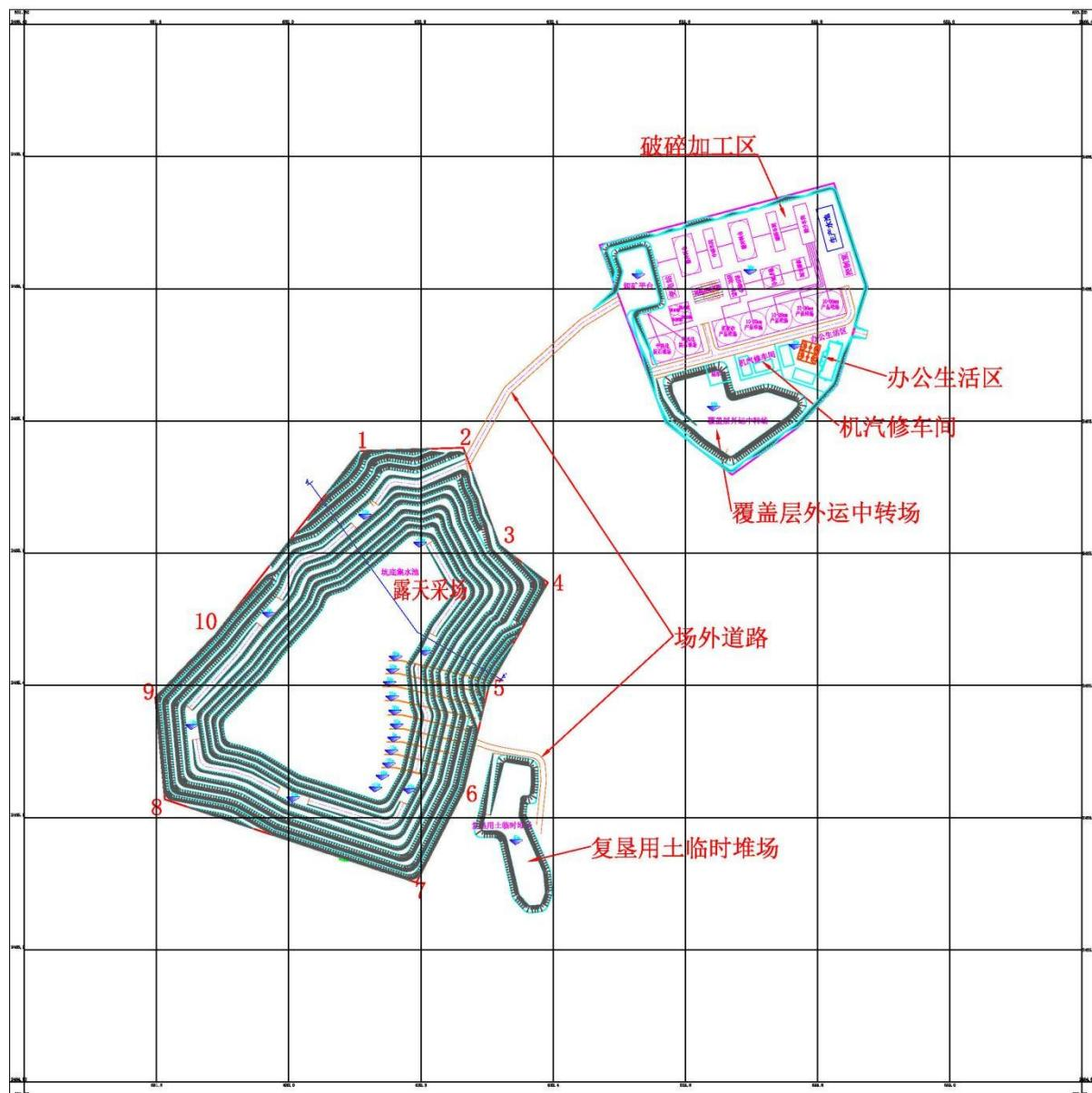
图 1-7 终了总平面布置图 (来源于: 《开采方案》)
