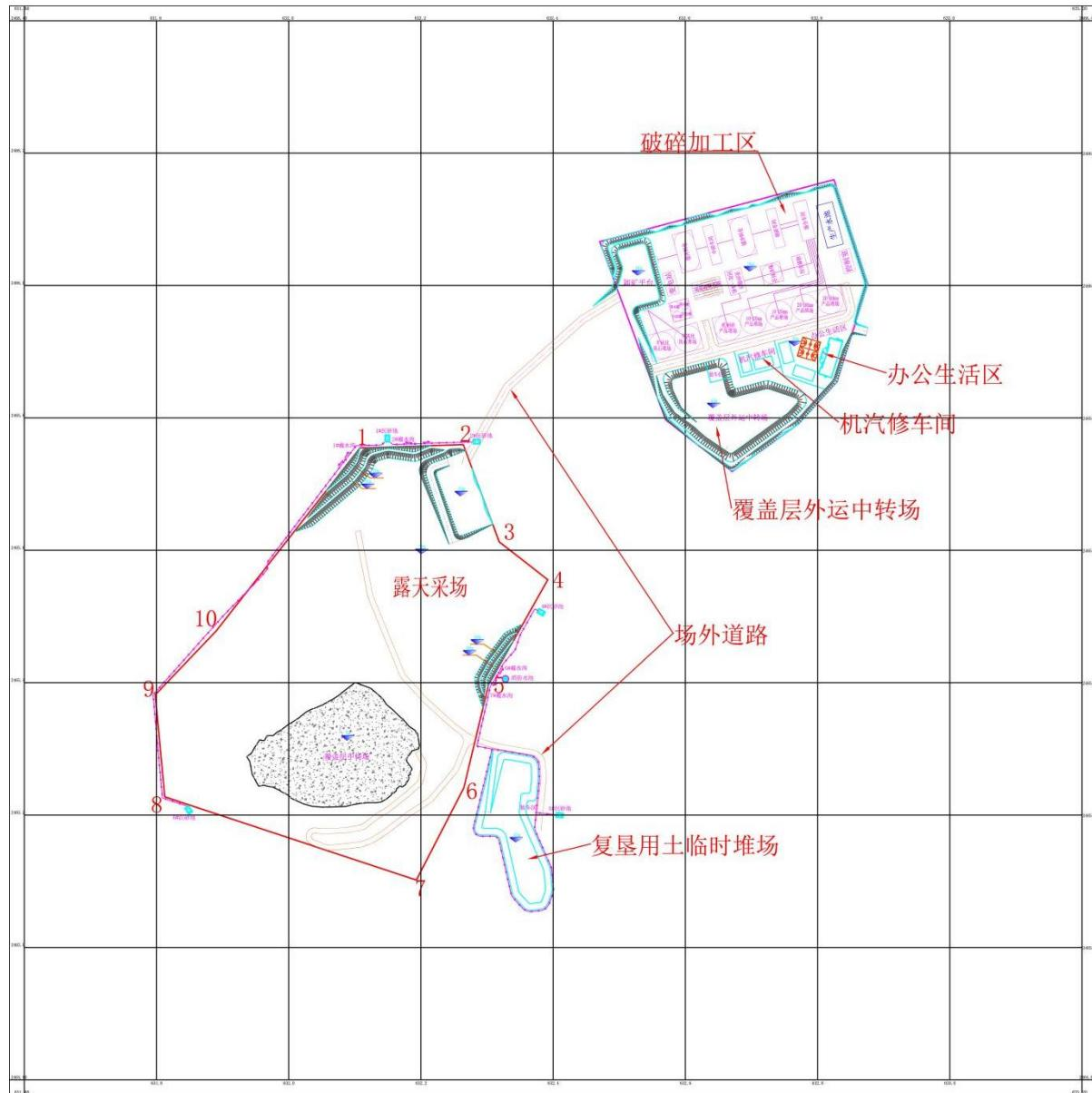
图 1-6 基建总平面布置图（来源于：《开采方案》）
