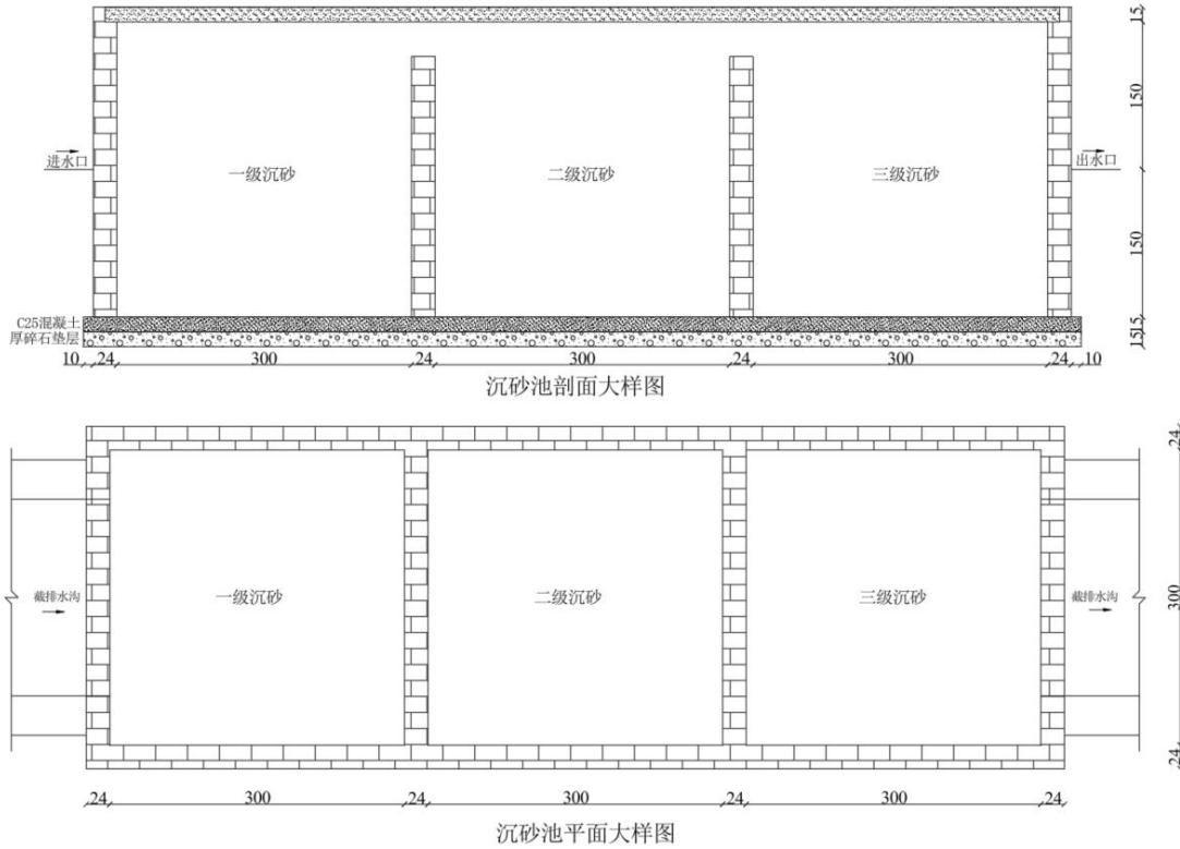
图 4-15 6#沉砂池设计大样图 (单位: cm)
