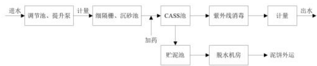
图 4-2 恩平产业转移工业园污水处理厂工艺流程图
