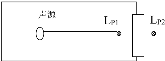
图 B.1 室内声源等效为室外声源图例
