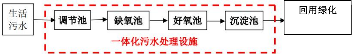
图 4-1 项目生活污水处理工艺流程图
